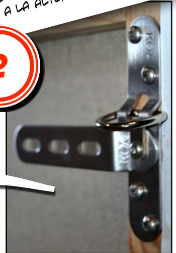
FIJAR LOS 2 CONJUNTOS DE ABAJO SIN ANILLOS EN EL SENTIDO INVERSO DE LAS PLETINAS DE ARRIBA (LA MARCA KOA HACIA ABAJO)
